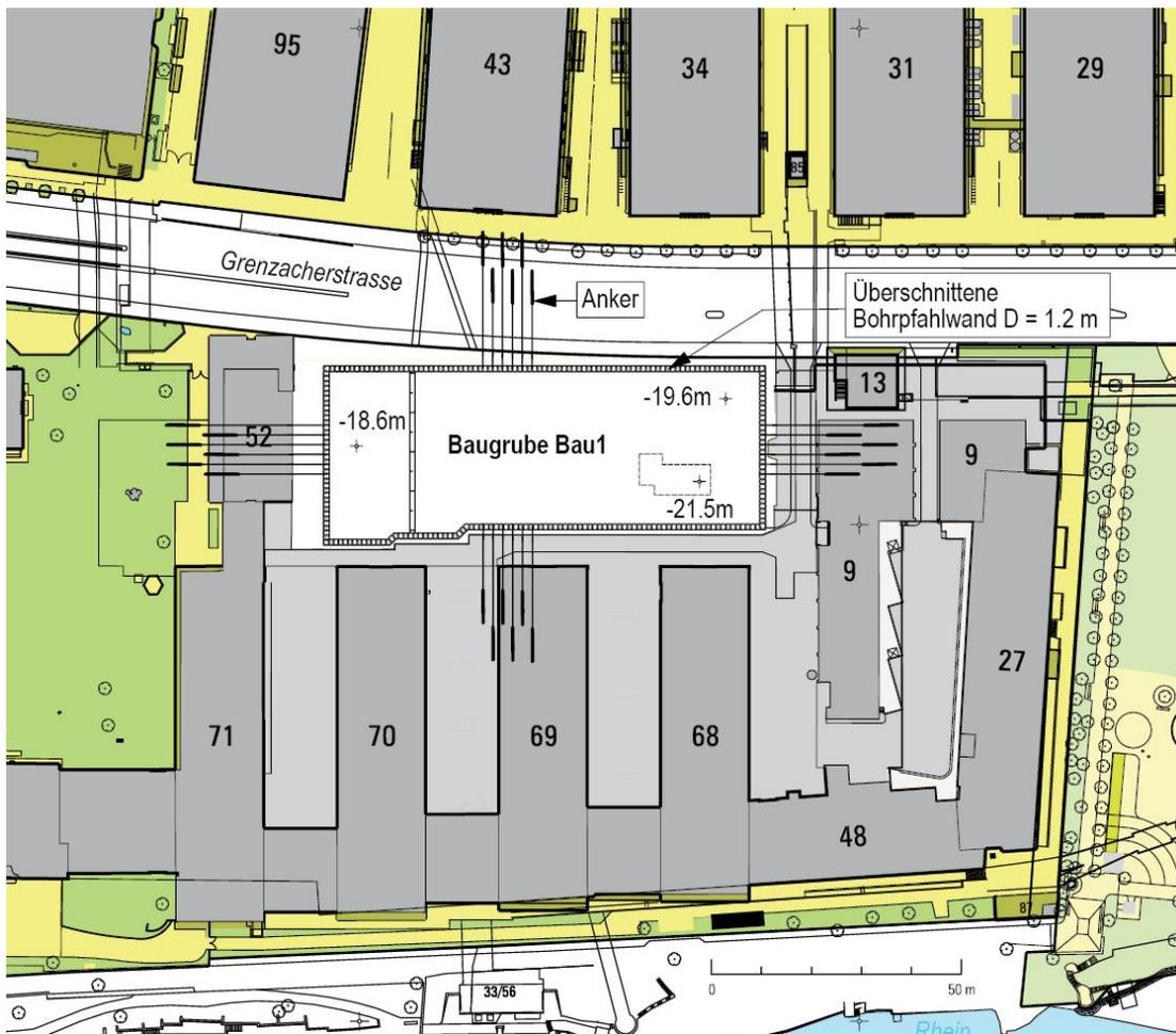
Bild 3: Grundrissituation mit Baugrube und umliegenden Nachbargebäuden
