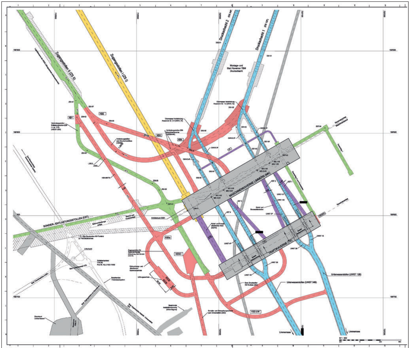
2 Stollensystem für Bau- und Betrieb der Kavernenzentrale
