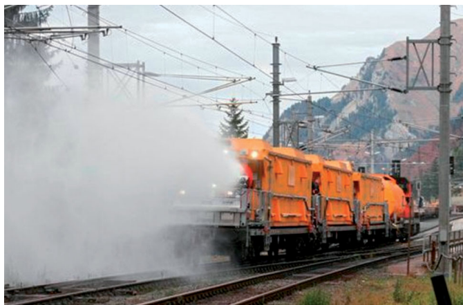
Fig. 2. Rescue train for use in the rail tunnel Bild 2. Rettungszug für den Einsatz im Eisenbahntunnel
